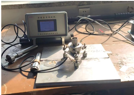
(a)KJS-3压痕应力应变测试仪
